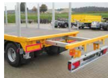
Sonderlösung: Heckauszug für Marti Bauunternehmung
