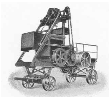
Selbstfahrender Betonmischer mit Winde
