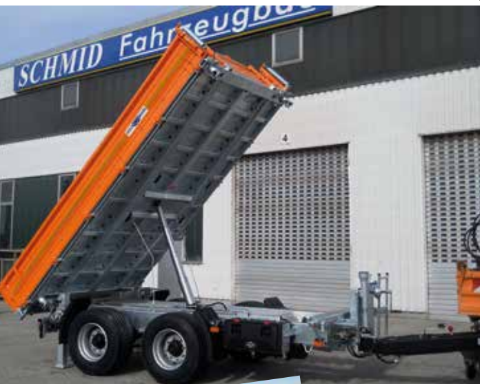
Kippanhänger mit Option Einschubrampen
