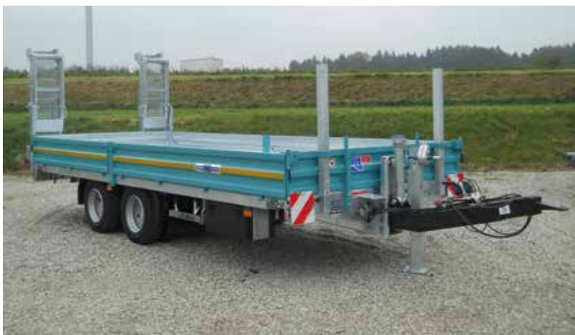
Maschinentransporter mit Klapp- und Einschubrampen
