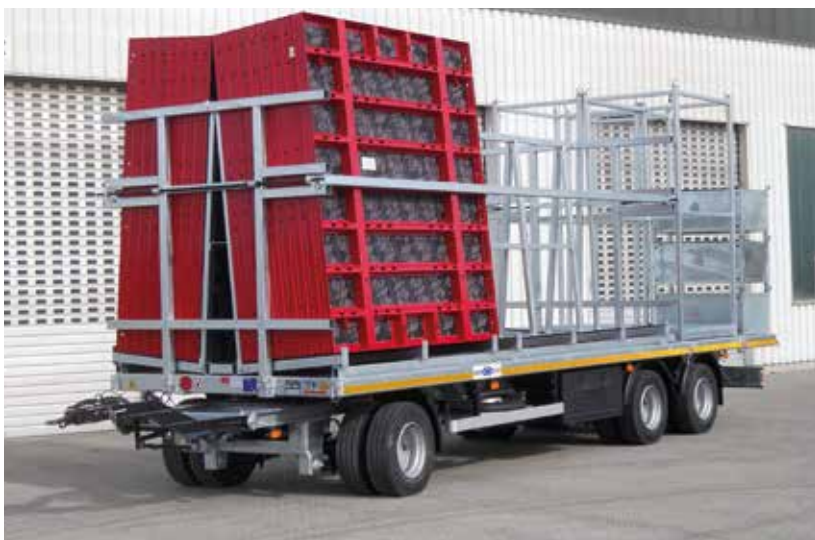
Spezialanhänger für Bau-Schalungen
