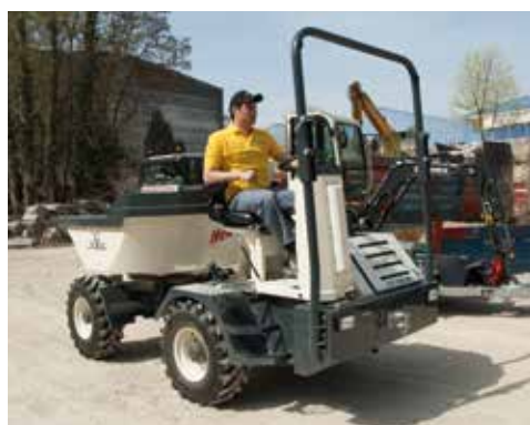
Spezialfahrzeug 4R1900RH mit Drehsitz
