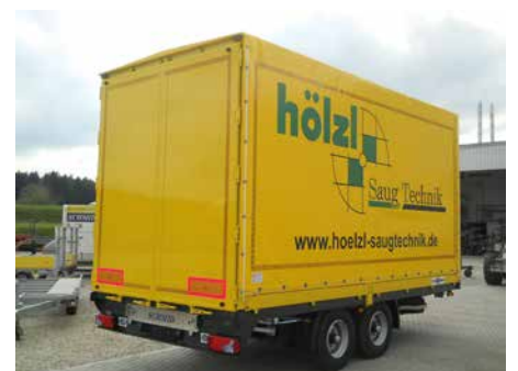
Abb. TUE 119 AR zul.GG 11.900 kg Hochplane und Doppelflügel-Hecktüren
