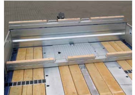
Stecker-Kassetten im Boden integriert Steckbare Maschinen-Anschlagschiene Staufach vorne, Mittel-Zurrschiene mit Klapp-Ringen
