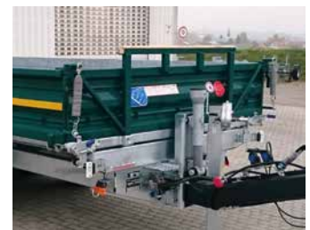
Laderschaufelauflage mit Holzeinlage auf der Stirnwand
