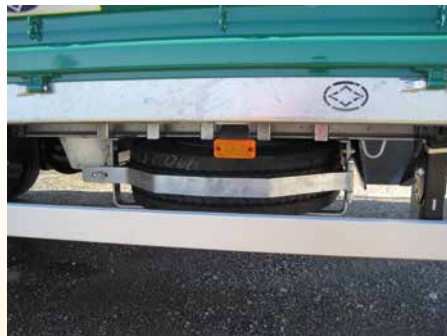
Ersatzradhaltekorb unter Brücke
