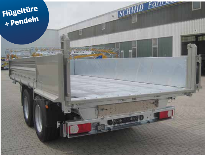
Abb. DK 190 AR zul.GG. 19.000 kg Heckwand in Kombination Pendelwand – Doppelflügeltüre (kein Abklappen möglich, manuelle Zentralverriegelung) Stahlbordwand verstärkt mit 3 mm Innenauskleidung, LED-Beleuchtung
