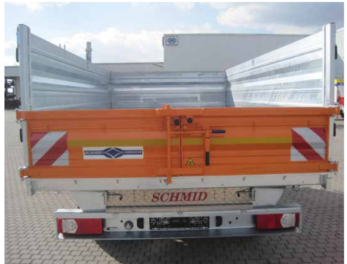
Rückwand als 2-flügelige-Schwenktüre, 270° umlegbar (kein Abklappen - kein Pendeln) in Verbind. mit Einschubrampen
