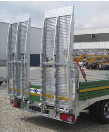
Rampe in der Länge 1-teilig, verbreitert ca. 2.300 x 930 mm (2 Bahnen Gitterrost), nur in Verb. mit Brücken-Heckschräge
