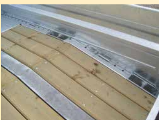
Sonderausstattung: Brücken-Heckschräge bei 50 mm mit Holz-Dielenboden
