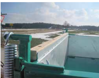
Bordwand-Verstärkung (3 mm Innenauskleidung) Laderschauflerauflage mit Holzeinlage auf der Stirnwand
