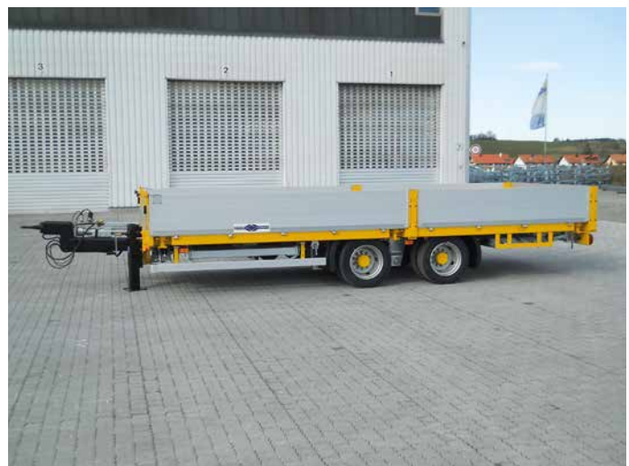
Abb. TUE 134 ZAR - Spezial Ges. Gew. 13.400 kg, Ladefläche verlängert auf 6.250 mm mit Mittelrungenteilung Weitere Sonderausstattungen: Luftfederung mit Heben+Senken, ALU-Wände silber eloxiert, Bodenrahmen verzinkt + lackiert, Sonder-Zugdeichsel mit liegender Verstellung, Stirnwand abnehmbar, Containerverriegelung, Steckungen mit Park- halterung unter der Ladefläche
