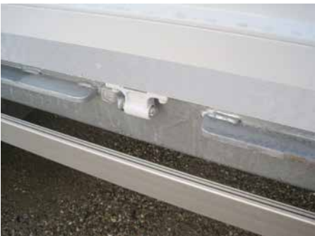
Stapler-Rammschutz für ALU-Wände an Bodenrahmen angeschweißt
