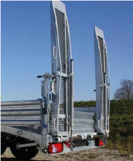
Rampe in der Länge 1-teilig, nur in Verb. mit Brücken-Heckschräge, Belag Gitterrost oder Holzdielen
