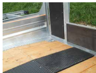
Sonderausstattungen: Brücke heckseitig abgeschrägt für flacheren Auffahrwinkel, Gummibelag rutschhemmend an Heckschräge und Rampen
