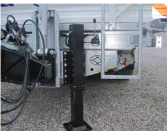
Hydraulische Abstellstütze vorne, Ölsversorgung vom Zugfahrzeug, Steuerventil a. d. Stütze, Aufstiegsleiter 3 Stufen
