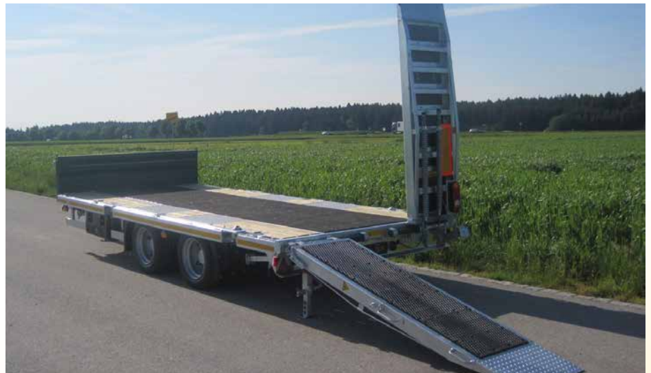
Verlängerte Rampe 1-teilig, ca. 2.800 mm lang, Gummi-Belag, hydraulisch. betätigt, in Verbindung mit hydraulischer Deichselverstellung zur Plateau-Schrägstellung
