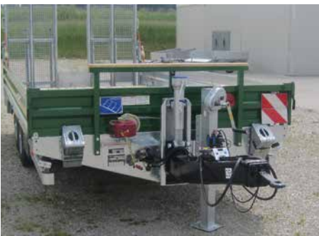
Laderschaufel-Bock auf der Stirnwand (Holzeinlage) Parkwarntafel faltpbar in FR links
