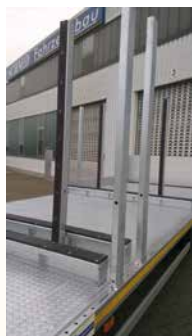
Steckerungen im Bodenrahmen mit Federstahl-Bolzen-Sicherung
