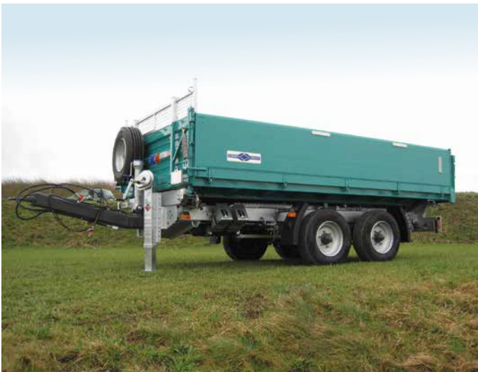
Abb. DK 119 AR zul.GG. 11.900 kg ALU-Bordwandaufbau seitlich und hinten (vorne Stahlwand) Stirnwand-Gittererhöhung, Ersatzteilhalter stirnseitig
