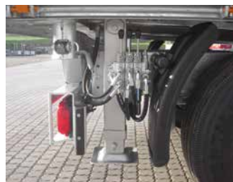
Hydraulische Heckabstützung, Ölsversorgung vom Zugfahrzeug, Steuerventil heckseitig
