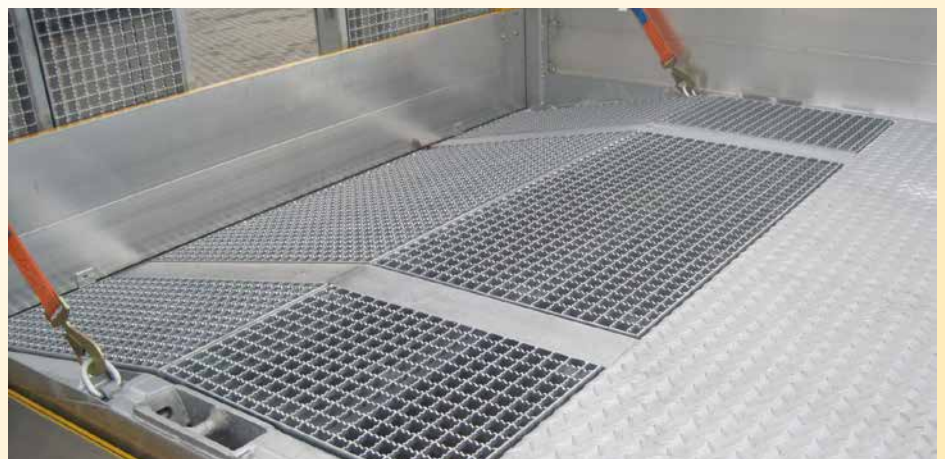
Rampenbelag aus Gitterrost gezackt, Heckschräge der Brücke mit Gitterrost gezackt
