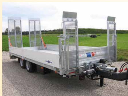
Überfahrampen zur LKW-Brücke Seilwinde stirnseitig (elektr.)
