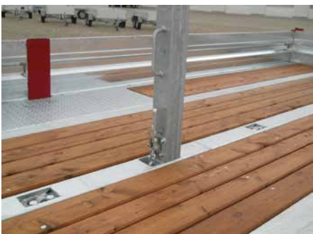
Mittelschiene mit Klapp-Zurr-Ringen, steckbare Rungen mit Spannverschluss
