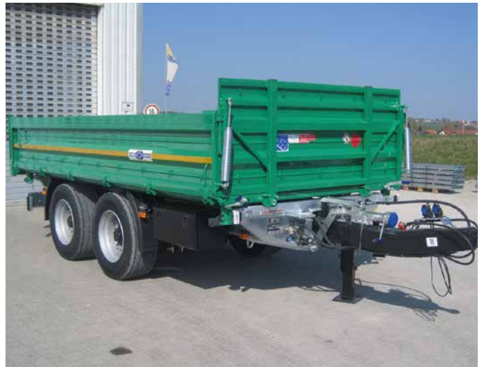
Abb. DK 190 AR zul.GG. 19.000 kg Stahl-Aufsatz-Stirnwand (1.000 mm ges. Höhe) Seitenwände erhöht auf 700 mm – verstärkt mit Randkastenrohr Heckwand 600 mm hoch (wegen Bodenfreiheit)
