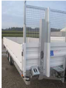
Verstärkte Stirnwand-Säulen Steckerungen Parkhalter stirnseitig
