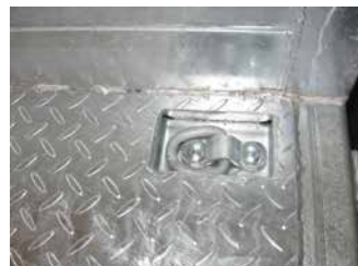
Serien-Zurring (max. 3 to.) bei MTT 750 – Pos. hinten versenkt (Abb. Blechboden verzinkt)
