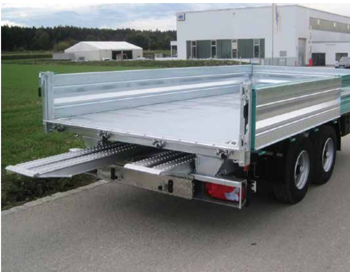
Rückwand als 1-flügelige Schwenktüre, 270° umlegbar (zus. Abklappen und Pendeln) ALTEC-ALU-Einschubrampen (8,7 to./Paar)
