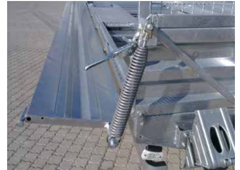
Seitenwand-Hebefeder für Stahl-Seitenwände 5.750 mm
