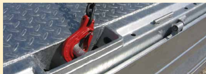
Serien-Detail: Schwerlastzurrstab (5 to. bis max. 7,5 to. – je nach Fzg.-Gewichtsklasse)
