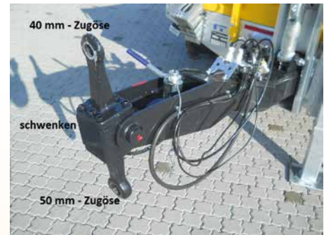
Schwenkzugöse mit 40 mm DIN-Öse und 50 mm DIN-Öse
