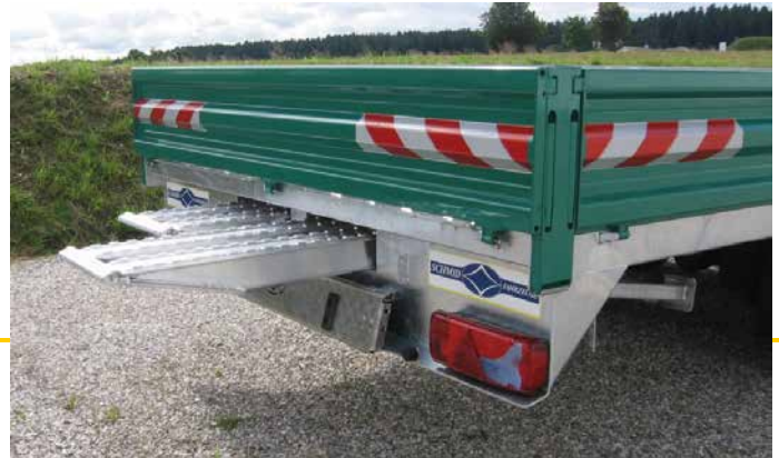
Serien-Rampenschacht mit ALU-Deckel klappbar und abschließbar Rampen-Abbrutschsicherung = Lochleiste, Heckabstützung klappbar
