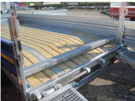
Steckbare Materialauflage – als Höhen-Ausgleich für Heckschräge (in Zurrstab-Öffnung)
