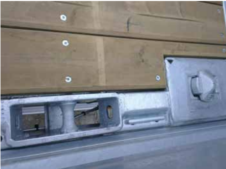
Serien-Zurrbügel (2 to.) hochziehbar Serien-Zurrstab (max. bis 7,5 to.) Containerverriegelung
