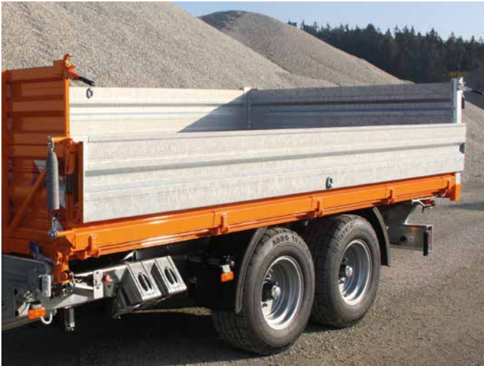
Aufsatzbordwände Stahl verzinkt, lackiert, abklappbar und pendelbar
