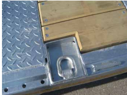
Klappbarer Zurr-Ring in 5 to.-/6,3 to.-/10 to.-Ausführung
