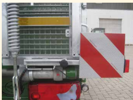
Warnpaket 3 m Breite – ausziehbar hinten (Warntafeln und Leuchten)
