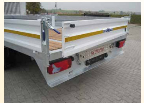
Heckwand Stahl als Schwenktür - 1-flügelig, mit Türfeststeller = 270° (Option: Verriegelungsstange mit 2 zus. Arretier-Stellungen = 110°/180°)
