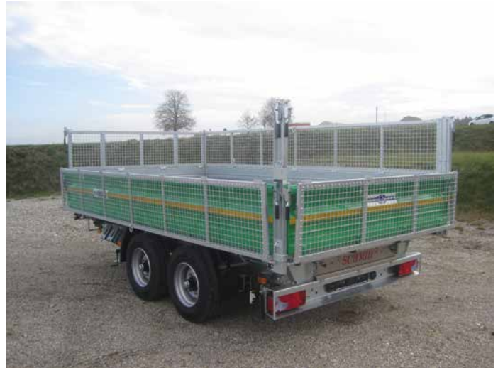
Aufsatzgitter Stahl verzinkt, abklappbar und pendelbar
