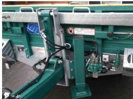
Hydr. Deichselverstellung und hydr. Stützfuß, mit Handpumpe oder Zugfahrzeug-Hydraulik
