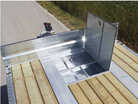
Staufach in der Ladebrücke vorne mit Deckel (eingeschränkt belastbar)
