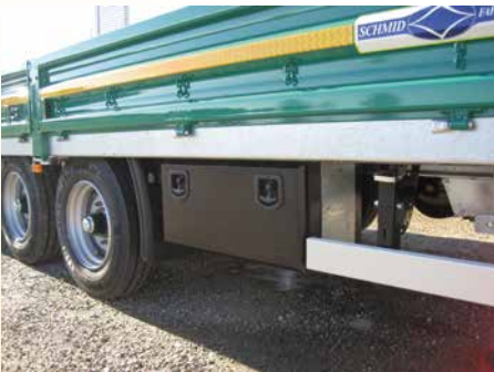
Staukasten aus Stahl unter der Brücke Netzhasen an Stahl-Bordwand
