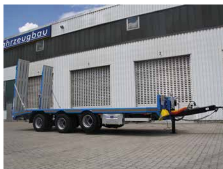
Tridem-Tieflader mit Nachlauf-Lenkachse, Liftachse
