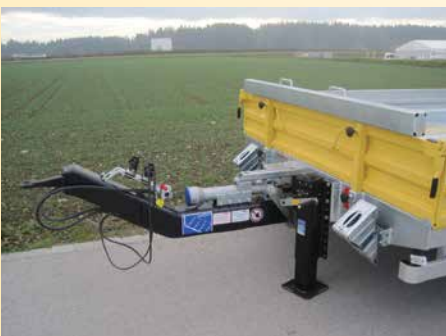
Liegende Deichselverstellung, Stirnwand abnehmbar = Überfahrvorbereitung Maschinen-Anschlagschiene in Parkstellung
