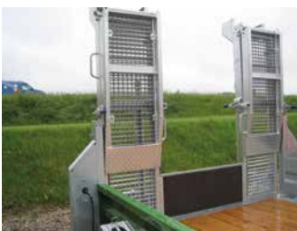
Sonderausstattungen: 2-teilige faltbare Rampe 3.000 x 480 mm für flacheren Auffahrwinkel
