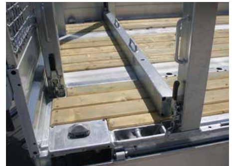
Containerverriegelung, verstellbare Maschinen-Anschlagschiene, steckbare Rungen mit Spannverschluss
