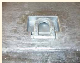
Zusatz-Zurr-Ringe versenkt (2,5 to.)
