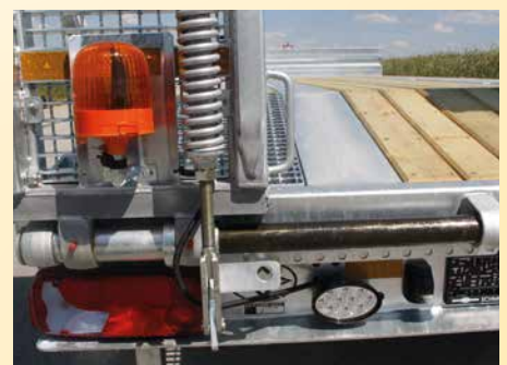
Rundum-Leuchte hinten (bei Warnpaket inkl.) LED-Zusatz-Rückfahrcheinwerfer im Unterfahrschutz
