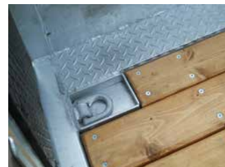
Serien-Zurring (max. 5 to.) ab MTT 890 – Pos. hinten versenkt (Abb. Holzboden)
