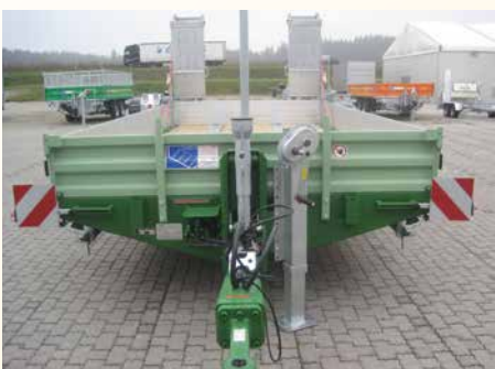
Warnpaket 3 m Breite – ausziehbar vorne (Warntafeln und Leuchten)
