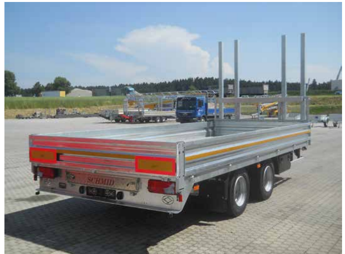
Abb. TUE 134 ZAR (Zwillingsbereifung) Ges. Gew. 13.400 kg, Ladefläche verlängert auf 5.750 mm mit Bordwandhebefeder Weitere Sonderausstattungen: Staukasten, Heckmarkierungs-Tafeln (ECE70), Stecksäulen mit Parkhalterung vorne
