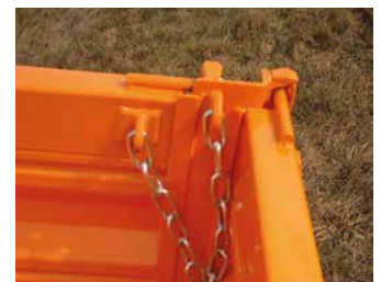
Auslegeketten für Seiten-/Heckwand
