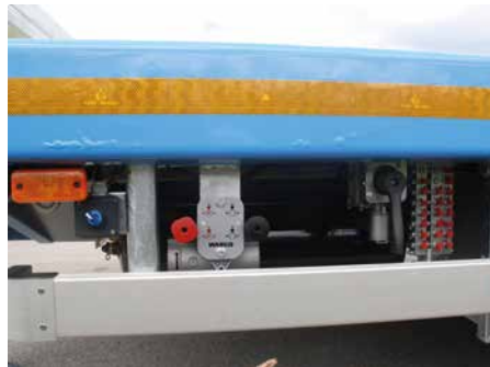
Löseventil Bremse/Federspeicher Luftfederung Heben/Senken-Drehschieber Achsen-Schmierstellen-Zusammenführung
