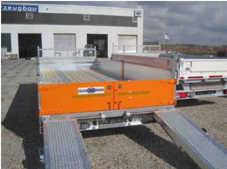
Heckwand ALU als Schwenktüre – 2-flügelig, mit Türfeststeller seitlich (270°)
