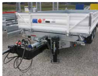
Liegende Deichsel-Höhenverstellung Stirnwand abklappbar, kurze Stützwinde = Überfahr-Vorbereitung vorne
