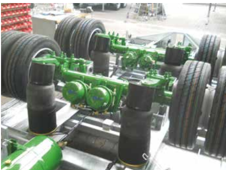
Luftfederung und Federspeicher-Feststellbremse
