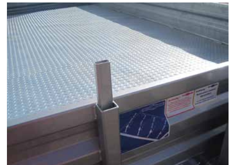
Parkhalterzapfen für TUE-Heckwand vorne aufsteckbar
