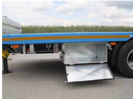
Maß-Staukasten aus Blech verzinkt unter der Brücke
