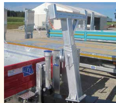
Fräsen-Förderband-Auflagebock, höhenverstellbar auf dem Deichselrohr
