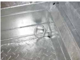
Serien-Zurring (max. 3 to.) bei MTT 750 – Pos. vorne (Abb. Blechboden verzinkt)
