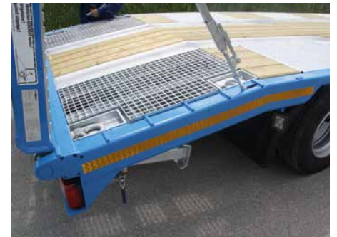
Klapp-Zurr-Ring (10 to), Gleitschutzroste gezackt, Steigleisten an der Heckschräge außen, Bodenrahmen-Lackierung zusätzlich in RAL
