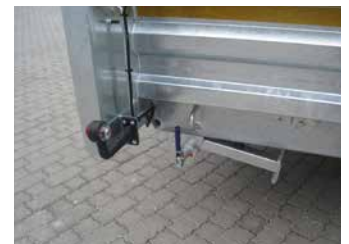
Serien-Klappstütze unter dem Rahmen heckseitig für Rampenbetrieb
