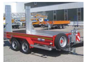
Abb. MTT 750 Sonderausstattungen: Alu-Rampen – anstelle Stahl-Rampen Bordwandaußenlackierung zus. zur Verzinkung, Ersatzrad stirnseitig
