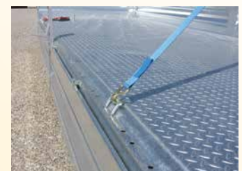
Serien-Detail: Hochziehbare Zurrbügel (2,0 to.)
