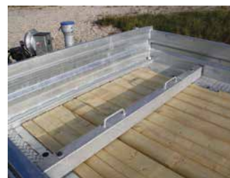
Sonderausstattung: Verstellbare Maschinenanschlagschiene
