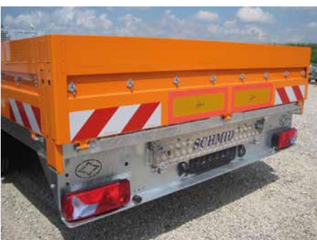
ALU-Wände mit Netzhaken-Vertiefung, Warnmarkierung DIN 30710 Heckmarkierungstafeln ECE 70
