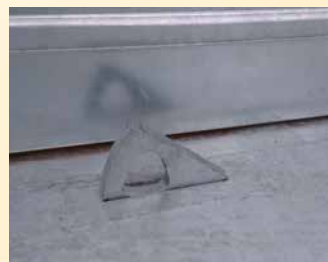
Zusatz-Zurr-Ringe versenkt hochziehbar (2 to.), Einbaulage längs oder quer zur Fahrtrichtung möglich
