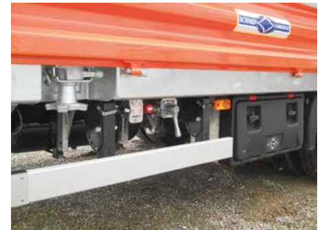
Containerverriegelung Staukasten aus Kunststoff unter der Brücke
