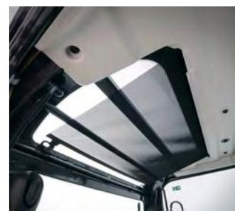
La finestra sul tetto cabina del modello SV60 è protetta da un parasole completamente integrato per offrire il massimo comfort.
